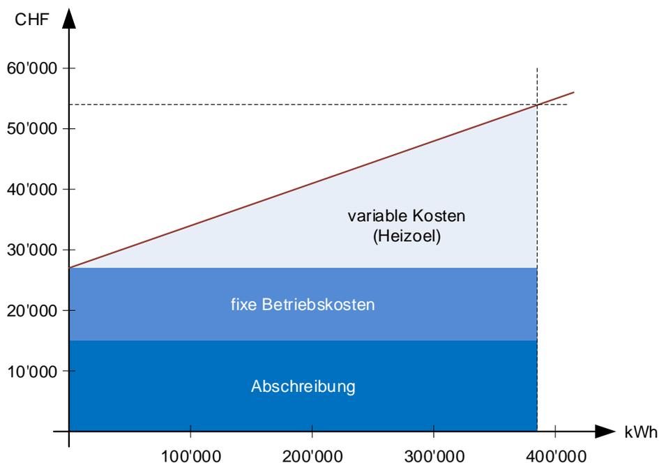
Anhand dieser Graphik kann abgeschätzt werden, wie sich ein reduzierter Verbrauch von Wärmeenergie (beispielsweise durch eine Verbesserung der Isolation der Gebäudehülle) auf die Heizkosten auswirken würde.
